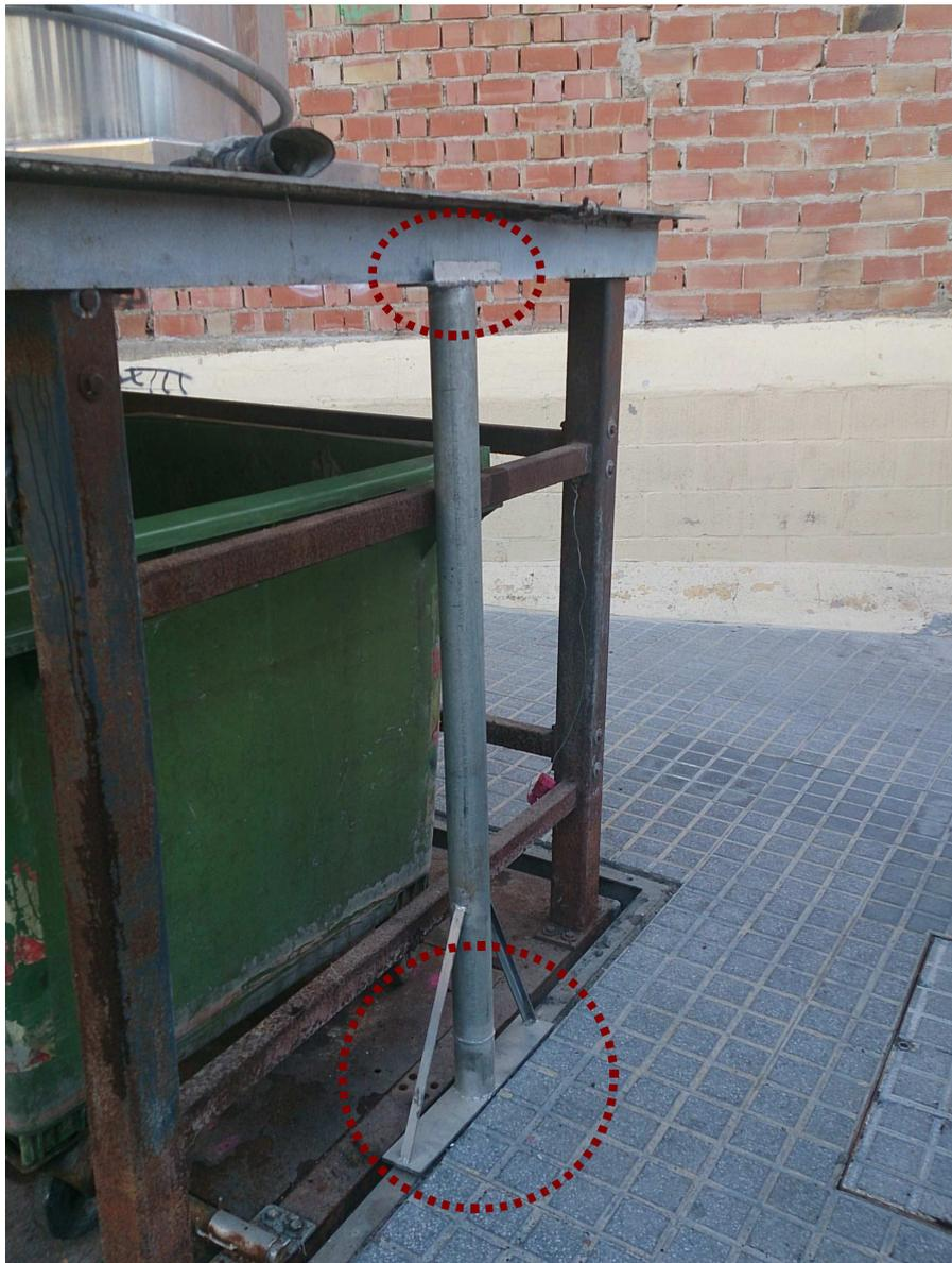
Se encaja entre la mesa y la estructura de forma que impide que baje accidentalmente la plataforma. Debe quedar ajustado entre ambos puntos. Se colorán siempre dos puntales (uno en cada lateral de la mesa).
